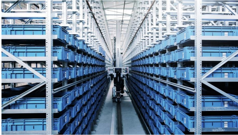
Abbildung 5: Automatisiertes Kleinteilelager (AKL) (Viastore, 2024)
